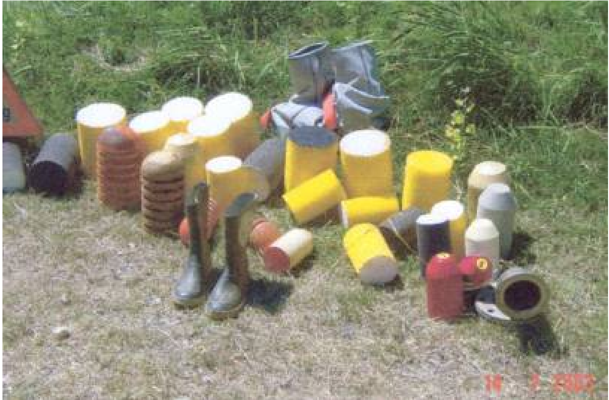
Abbildung 10: Molche unterschiedlicher Form und Härte (Fa. MTA)
