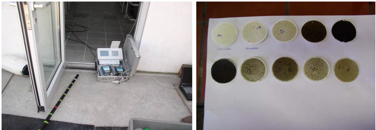
Abbildung 15: Sielhautmenge Bestimmung mittels Trübungssonde bzw. Membranfiltration
